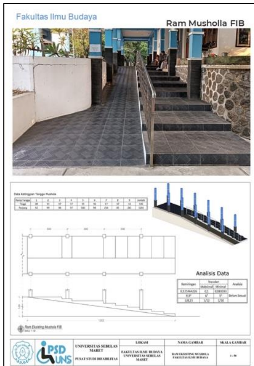
Gambar 16. Kondisi Eksisting Prasarana Ramp di Musala FIB UNS
