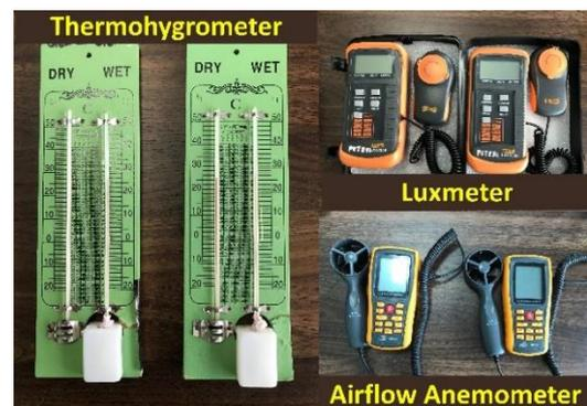
Gambar 6. Alat Ukur Temperatur, Kelembaban, Iuminansi, dan Kecepatan Angin
