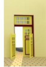
Pintu ganda dengan lapisan pertama daun pintu menutup dari atas ke bawah lubang pintu dan lapisan kedua menutup dari setengah tinggi lubang pintu sampai ke bawah
