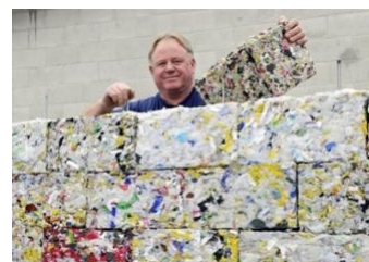
Gambar 10. Pengelolaan Limbah Botol Menjadi Bahan Bangunan Sumber: constructionjunkie.com
