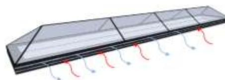
Gambar 15. Pertukaran Udara Pada Ventilasi Skylight
