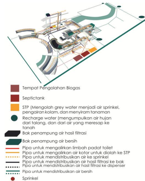
Gambar 13. Kontrol Lingkungan pada Bangunan
