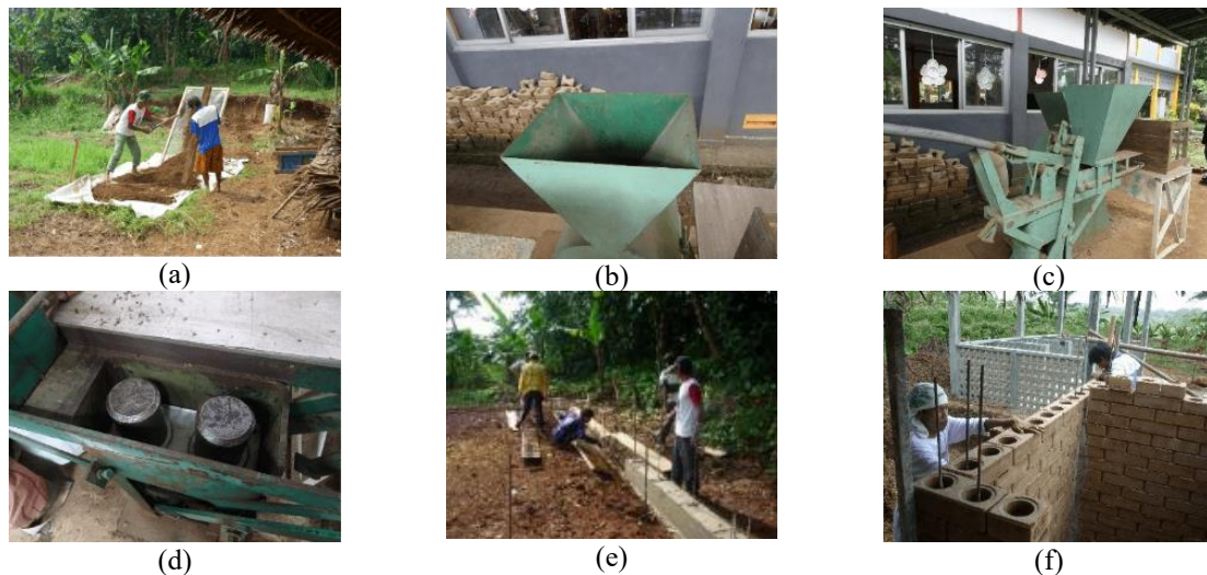
Gambar 2. Proses Produksi Bata Ekologis (a) Proses Penyaringan Tanah, (b) Proses Pencampuran Bahan Baku, (c) Mesin Pencetakan, (d) Cetakan untuk Memadatkan Bata Ekologis, (e) Proses Pemasangan Tahap Sloof, dan (f) Proses Pemasangan dengan Tulangan.
