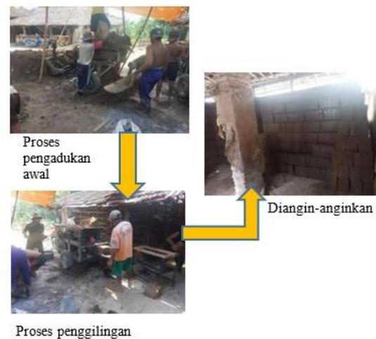
**Gambar 7.** Proses Pencetakan Genteng hingga Penjemuran
